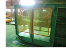
メインスイッチ安全カバー (スイッチ付) カバーを外すと機械が全停止します
